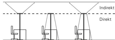
Direkt- und Indirektlicht sind getrennt schalt- und dimmbar.
